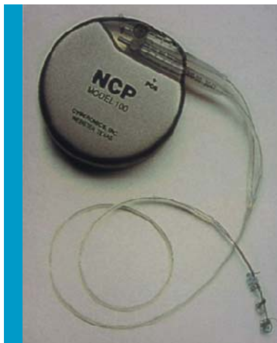
Figuur 1. Het implanteerbare nervus vagus stimulatie systeem: de pulsgenerator en de bipolaire lead met elektroden.
